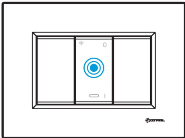
Si usted necesita resetear y volver a emparejar el dispositivo, prenda y apague el Módulo Inteligente 5 veces rápidamente hasta que la luz indicadora parpadea rápido al entrar nuevamente en Modo de Emparejamiento.
