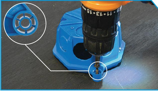
**1** Fija la caja al encofrado utilizando tornillos o clavos convencionales. El exclusivo **sistema de fusibles VIVION** permite una sujeción firme durante todo el proceso de obra, asegurando estabilidad y facilitando el desmontaje posterior.
