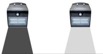
**Modo B:** Encendido automático al 100% (400 LM) al detectar movimiento. Luego de 20 segundos sin detectar movimiento pasa a un 10%.
